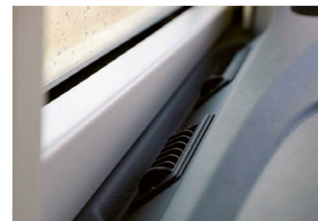
Doble glass i sidevinduene foran og ventilasjon rettet mot nettopp vinduene er viktig for å få en godt fungerende helårsbil.
