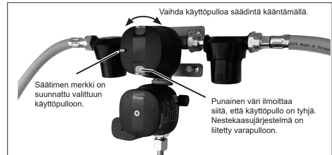
Truma DuoControl on tarkoitettu kahdelle nestekaasupullolle.
