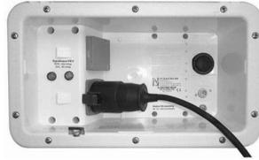
Bei Elektrobetrieb muss der Wohnwagen an das 230V-Netz angeschlossen sein.
