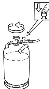
Der Crashsensor blockiert die Gasanlage, wenn diese einer unnatürlich starken Beschleunigung ausgesetzt wird. Dadurch soll eine Gasleckage im Falle eines Verkehrsunfalls verhindert werden.
