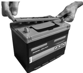
Kontrollieren Sie regelmäßig den Flüssigkeitsstand der Batterie, der ca. 5-10 mm über den Polplatten liegen soll.
