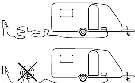
*Spannungsabfall im Kabel bei einer Belastung von 10 A.*
