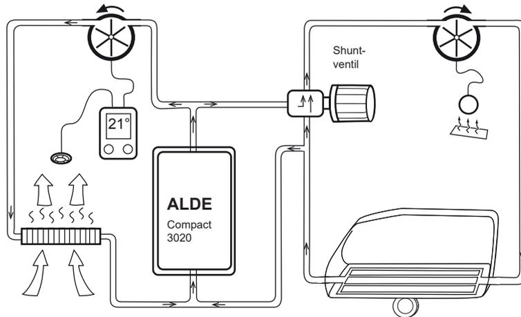
Frischluff wird in den Konvektoren erwärmt und steigt entlang der Wände nach oben.
