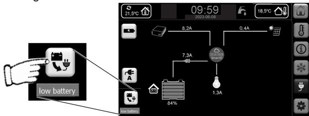
Die elektrische Anlage wird automatisch wieder aktiviert, wenn die Batterie vollgeladen ist. Das vollständige Aufladen der Batterie nimmt einige Stunden in Anspruch.
