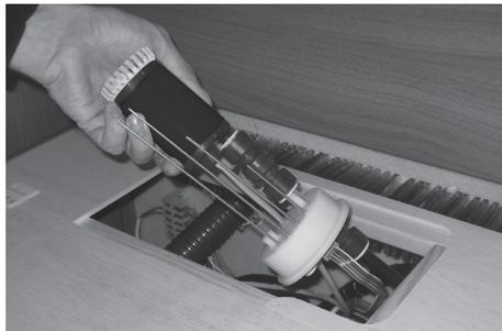
Wasserpumpe entleeren. Dazu die Pumpe so halten, dass das Wasser aus dem Entleerungsventil des Kaltwasser-Schlauches laufen kann.
