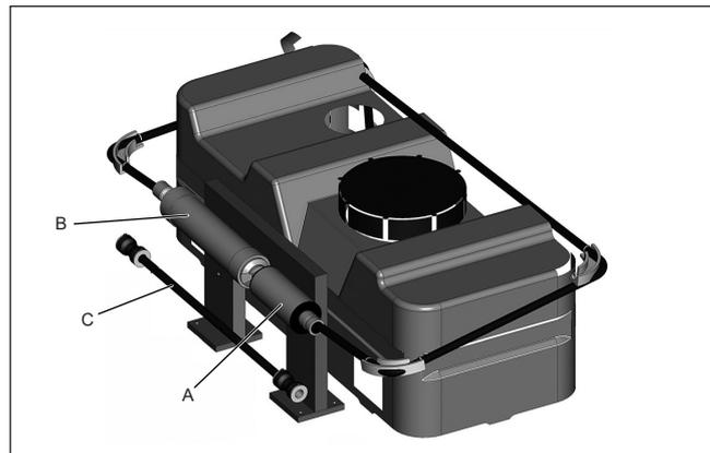
*Die Einheiten des Wasserreinigungssystems sind an den Frischwassertank montiert.*
