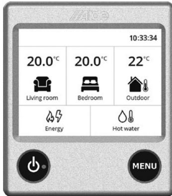
Die Heizung (der Heizkessel) wird über eine separate Bedientafel bedient.
