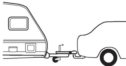
Zum Rangieren des Wagens nicht den Handgriff der Kugelkupplung verwenden. Dadurch könnten innere Teile beschädigt werden.
