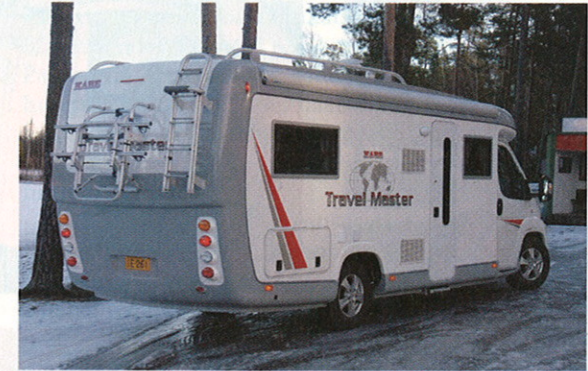
Markiisi on integroitu lasikuitu- vahvisteiseen muovikattoon.
