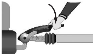
Påkopplad och stabiliserad
