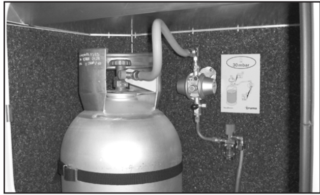
Gasolflaskan i gasolkofferten.
