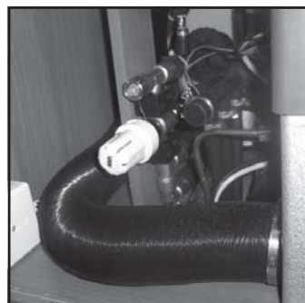
Shuntventil för golvvärme (endast vissa husbilar).
