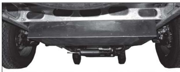
Gråvattentanken monterad mellan husbilens bakhjul.
