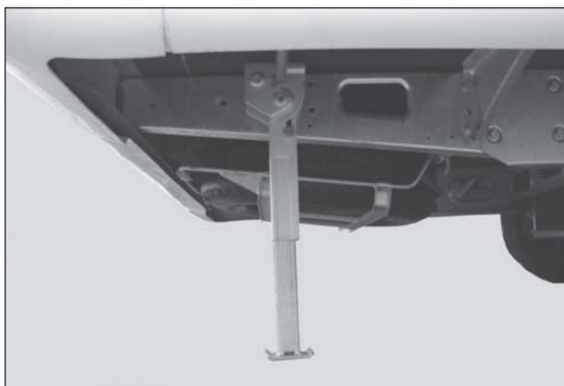
Stödbenet nervevat för att stabilisera husbilen.
