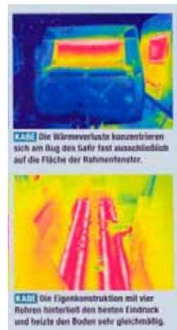
Det tyska testet kontrollerade man med värmekamera hur värmen spred sig i vagnarna.
