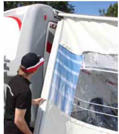
9. Pressa gummivulsterna mot väggen, spänn stödbenet mot marken, skruva åt låsskruven och slå ned markpinnarna i marken. Fäst de diagonala förstärkningsrören mellan överliggarna och stödbenen. Spänn och skruva åt.
