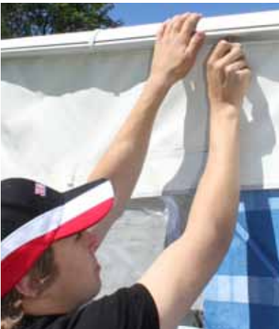
7. Lägg markisväven på överliggaren och kläm fast den med de tre spännskruvarna. Justera markisens ben, så att du får gaveln i rätt vinkel mot husbilen. Gör likadant med den andra gaveln, och veva sedan in markisen så att väven sträcks och överliggaren sitter fast.
