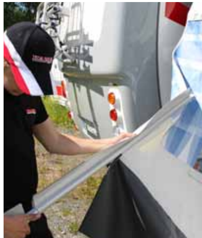
8. Montera samman stödbenen med gummivulsterna, som skall täta mot husbilens vägg, och fäst dem i gavlarna.
