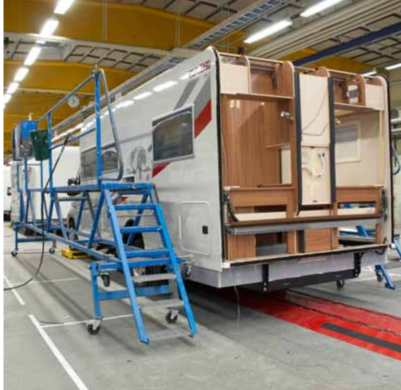
Den 102 meter långa motoriserade linan rymmer 10 bilar och hastigheten bestäms utifrån efterfrågan.
