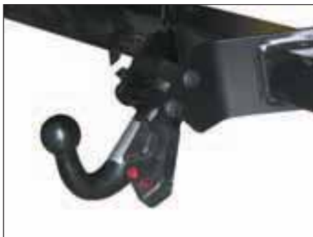
DRAGKROG Y0340 Med löstagbar kula. Drar 1735 kg.
