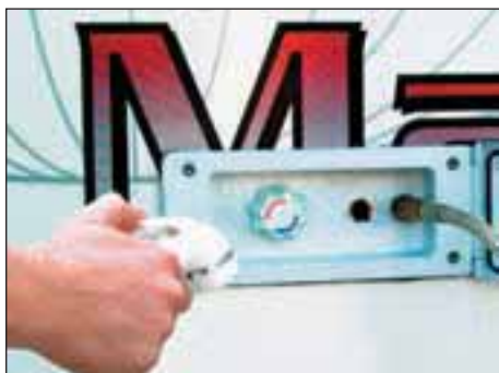
UTVÄNDIGT DUSCHUTTAG Y0100 Med varmvatten.
