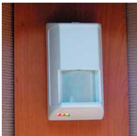
LARM Y0167 ▲ Inbrottslarm, bil- och bodel.
