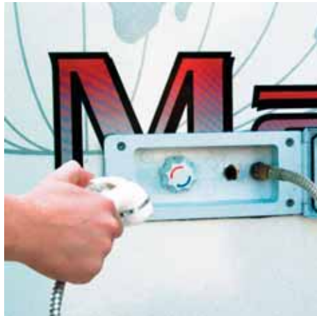
UTVÄNDIGT DUSCHUTTAG Y0100 ▲ Med varmvatten.
