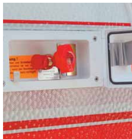
UTVÄNDIGT GASOLUTTAG ▲ För inkoppling av gasolgrill utomhus.
