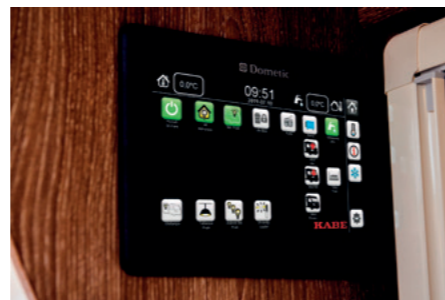
På startsidan visas alla knappar för belysning och digitala skjutreglage för dimmer. Här ser du också temperatur, både ute och inne, och klocka.
