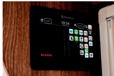
All information och styrning gällande värme visas på en egen sida. Här höjer och sänker du värmen smidigt med digitala skjutreglage.
