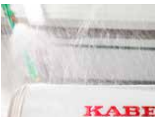
Regnkammare. I regnkammaren sprutas husbilarna under högt tryck.
