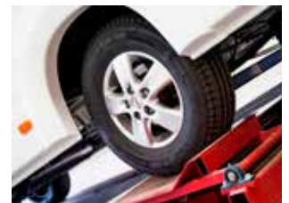
Hållbarhetstest körning. Hållbarhetstest simuleras i en skakbänk motsvarande 10 000 mil normal körning.
