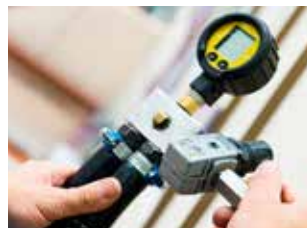
Gasol. Gasolsystemet trycktestas.
