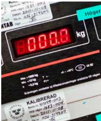
Vågar för att balansera och optimera viktfordelning mellan axlar.
