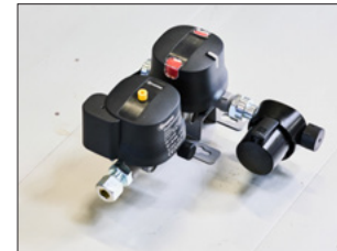
Duocontrol. Duocontrol har inbyggd automatisk gasomkopplare, reduceringsventil och krocksensor som löser ut vid sammanstötning med en G-kraft på 3,5 G. Gasol-tillförseln stängs då av direkt för att undvika gasläckage. Duo Control är godkänd i hela Europa för att ha gasolen igång under färd.
