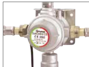
Duocontrol. Duocontrol har inbyggd automatisk gasomkopplare, reduktionsventil och krocksensor som löser ut vid sammanstötning med en G-kraft på 3,5 G. Gasoltillförseln stängs då av direkt för att undvika gasol-läckage. Duo Control är godkänd i hela Europa för att ha gasolen igång under färd.
