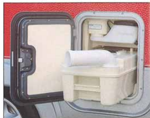
Royalvagnarna har fast installerad spoltoilet där tömning kan ske utifrån - hygieniskt och smidigt.
