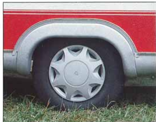
Samtliga KABE-vagnar har åttalagrade däck som klarar högre belastning än vad husvagnen normalt utsätts för
