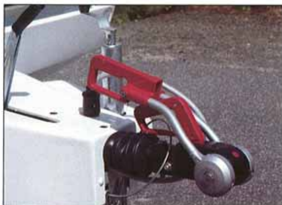
Krängningshämmande friktionskoppling underlättar i trafiken
