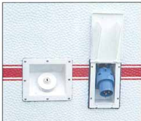
Vattenpåfyllning och elanslutning är utvärdig placerade och lätt åtkomliga
