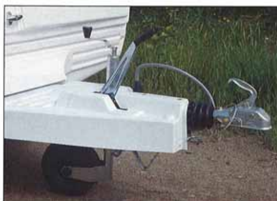
Kapslat drag i ABS ger fronten en elegant design samtidigt som känsliga delar hålls rena från smuts
