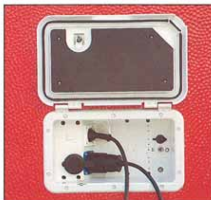
Den utvändiga ellådan innehåller 220V in- och uttag, 12V uttag samt centralantennanslutning
