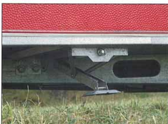
Chassit och stödben är helgalvaniserat och dimensionerade för att tåla hårda påfrestningar
