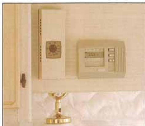
Elektronisk termostat och panel för klimatanläggningen ger kontroll över vagnens inneklimat
