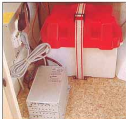
Elcentralen med den effektiva LEAB-laddaren är en tillgång såväl sommar som vinter
