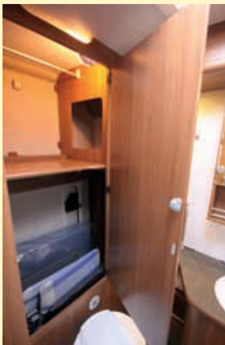
En stor skapdør på toalettet førte ut til det utvendige skapet. Som det høyre bildet viser er toalett-tanken plassert på innerveggen i skapet. Det betyr at man må tømme skapet for å få tømt tanken.
