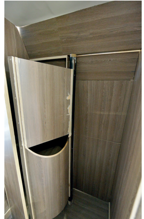
▲ Badrummet är vad vi på tidningen kallar trolleribadrum. Antingen dusch eller toalett. Även här testas mått och funktion i modell av trä. När man vet exakt hur det ska vara görs utrymmet i rotationsgjutet plast.
