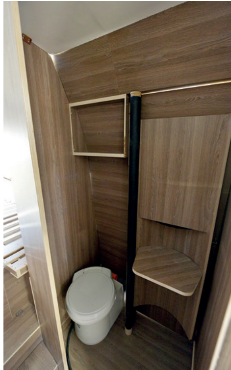
▲ Badrummet är vad vi på tidningen kallar trolleribadrum. Antingen dusch eller toalett. Även här testas mått och funktion i modell av trä. När man vet exakt hur det ska vara görs utrymmet i rotationsgjutet plast.
