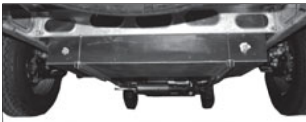
Grävattentanken monterad mellan husbilens bakhjul.
