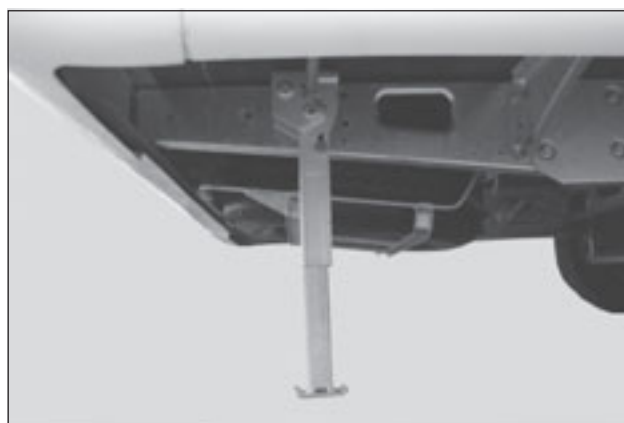
Stödbenet nervevat för att stabilisera husbilen.
