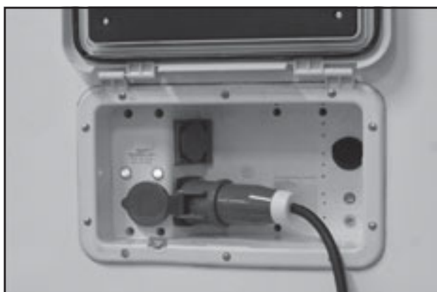
Uppvärmning med elpatron förutsätter 230V matning.
