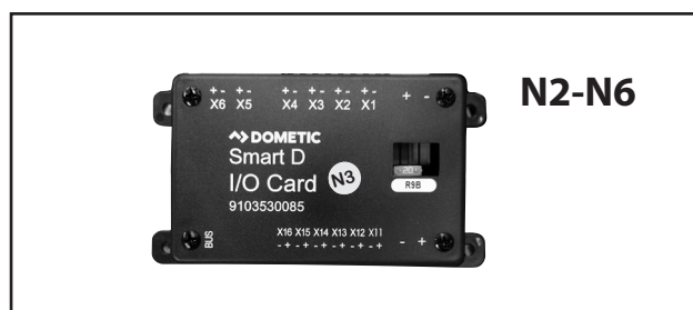
Bilden visar en av elsystemets enheter N2-N6. Dometic Smart D I/O Card.
