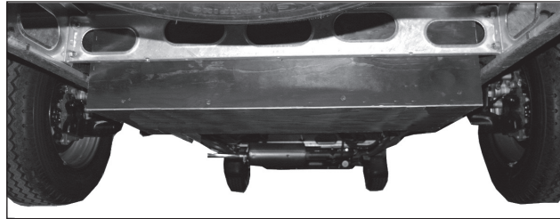
Gråvattentanken monterad mellan husbilens bakhjul.
