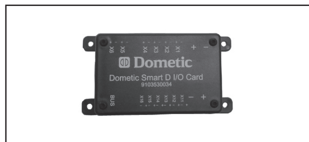
BUS-systemets station för 6st elektriska ingångar och utgångar.
