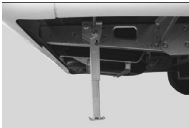
Stödbenet nervevat för att stabilisera husbilen.
