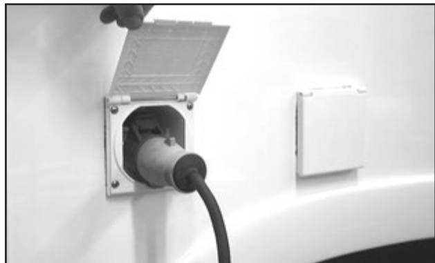
Uppvärmning med elpatron förutsätter 230V matning.
