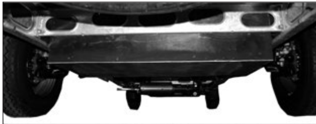
Gråvattentanken monterad mellan husbilens bakhjul.
