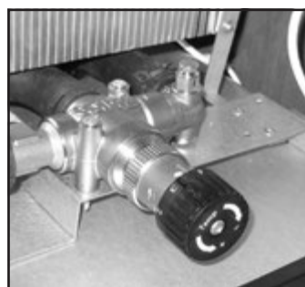
Shuntventil för golvvärme (endast vissa husbilar).
