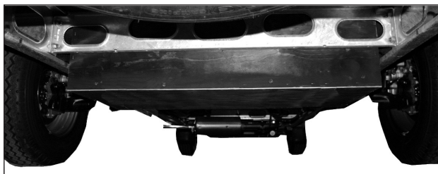
Gråvattentanken monterad mellan husbilens bakhjul.
