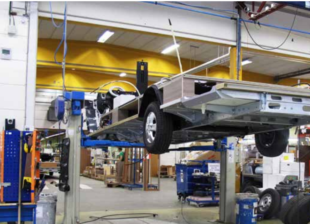
Husbilens nakna chassi rullas ut på produktionslinjen
