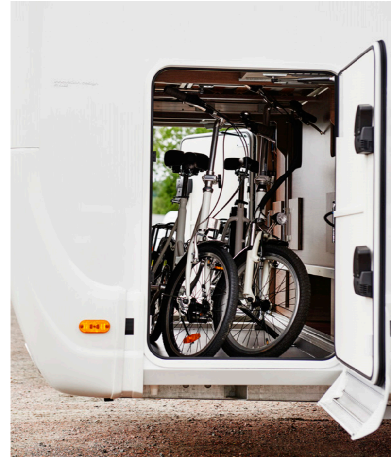
Praktiska förankringsöglor på skenor i garageutrymmet hjälper till att hålla allt på plats.
