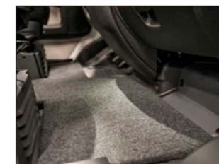
Värme matta i hytt med värme i insteg Värmeväxlare
