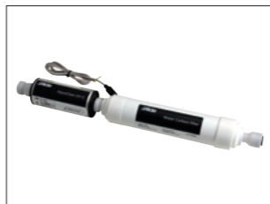
"Vattenrening" – Alde AquaClear UV-C (till panna Alde Compact 3030). Effektiv vattenrening som skyddar användarens hälsa på ett skonsamt och miljövänligt sätt. Oönskade virus och bakterier, bekämpningsmedel och kemikalier avlägsnas. Vattnet desinficeras genom UVC-ljus genererat från lysdioder. Därefter går vattnet även genom att kolfilter som ger ett luktfritt vatten utan dålig smak eller färg.
