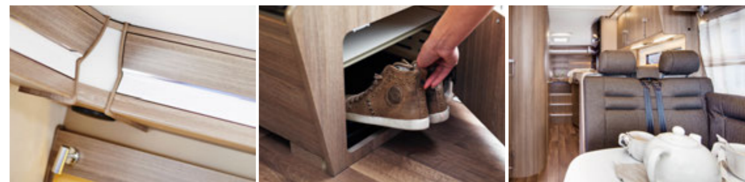
I överskåpen finns en hylla, inbyggda luftkanaler, mellanväggar, gasdämpare och trycklås.
