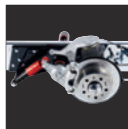
Luftfjädring AL-KO (fram/bak) 780, i760, i810 X4 tvåaxling 880, i860, i910 X4 treaxling i810 Tandem X4 treaxling
