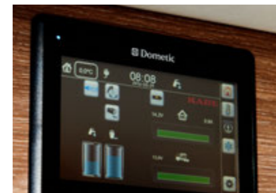
Aktuell statusinformation om färskvattennivå, gråvattennivå och batterispänning visas på ett överskådligt sätt.
