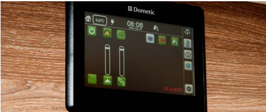
På startsidan visas alla knappar för belysning och digitala skjutreglage för dimmer. Här ser du också temperatur, både ute och inne, och klocka.
