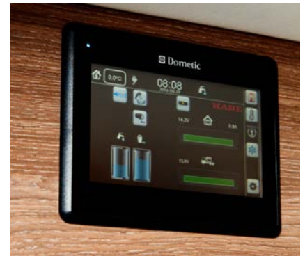
Aktuell statusinformation om färskvattennivå, gråvattennivå och batterispänning visas på ett överskådligt sätt.
