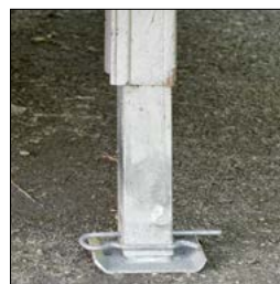
Stödben bak Y0368 780, 880, i760, i810, i860, i910 Hydrauliska stödben
