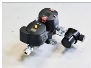
Duocontrol. Duocontrol har inbyggd automatisk gasomkopplare, reduceringsventil och krocksensor som löser ut vid sammanstötning med en G-kraft på 3,5 G. Gasoltillförseln stängs då av direkt för att undvika gasolleckage. Duo Control är godkänd i hela Europa för att ha gasolen igång under färd.
