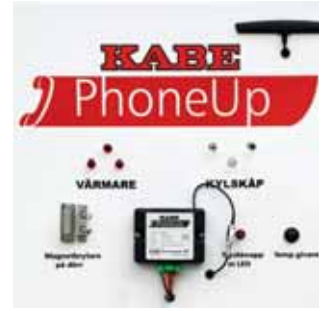
Phone Up GSM-baserat larm via mobiltelefon. Styrning av värme och kylskåp, övervakning ytterdörr, spänningsnivå och temperatur (standard i Hacienda).
