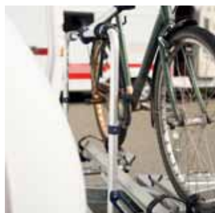
Cykelhållare (X0281) Monteras på draget. Håller för vikter upp till 50 kg (2 cyklar).
