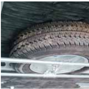
Reservhjulshållare (X0063) under chassi
