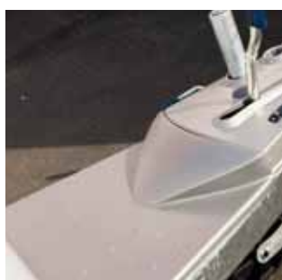
Täckkåpa dragbalk (X0269) Täckkåpa med fotsteg passar fint över dragbalkarna. Håller att stå på. Boggie (X0284) Enkel (X0283)
