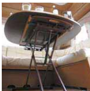
Saxstativ (X0003) Bordet med saxstativ gör det enklare att fälla ner när framgruppen skall bäddas.
