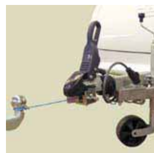
Puller Winch (X0204) För säker uppkoppling. Puller Winch passar de flesta kulkopplingar och manövreras med hjälp av ett spårskafat med 17 mm hylsa.
