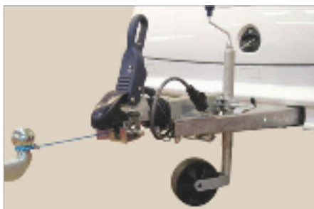
Puller Winch X0204 För säker uppkoppling. Puller Winch passar de flesta kulkopplingar och manövreras med hjälp av ett spårskafvt med 17 mm hylsa.
