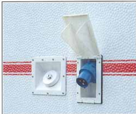
Vattenpåfyllning och elanslutning är utvändigt placerade och lätt åtkomliga.
