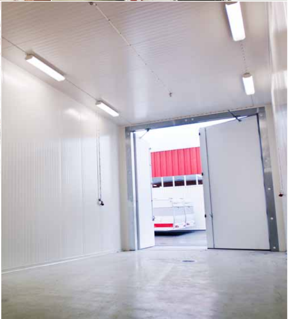
Mikael Blomqvist, teknisk chef på KABE, visar den enorma köldkammaren som är unik i branschen; här testas både husvagnar och husbilar – till och med den 11 meter långa Hacienda får plats – i -30^{\circ} och upp till +55^{\circ} . Överst; 4 individuella vågar finns fast monterade i golvet. I regnkammaren besprutas vagnarna och bilarna under högt tryck.
