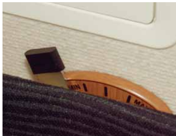
Med ett reglage bakom ryggstödet öppnar eller stänger man lätt spjället över den extra ventilationsöppningen.
