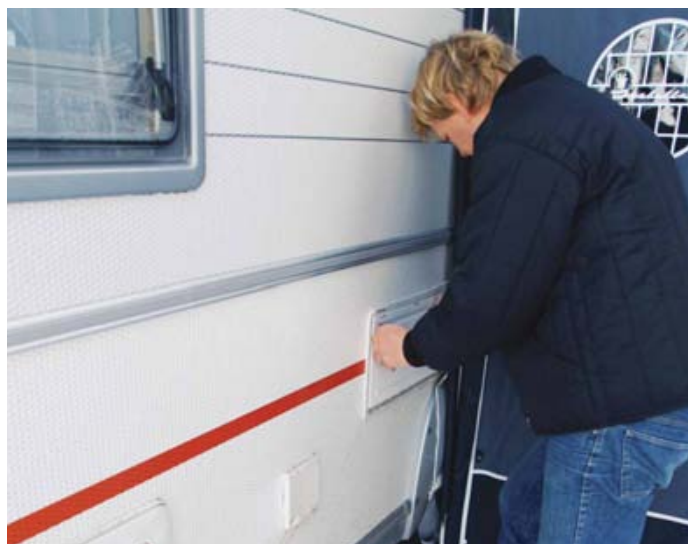
Vintertid og koldt vejr – jamen, så skal vinterristen da monteres over køleskabets udluftningsrist.
