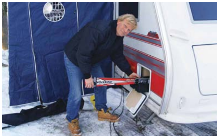
Kabe karrosseriet har mange smarte detaljer, bl.a. serviceklap til ski, som stuves under siddegruppen, og et strømudtag samt et udvendigt bruseudtag mv.
