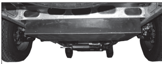
Gråvattentanken monterad mellan husbilens bakhjul.
