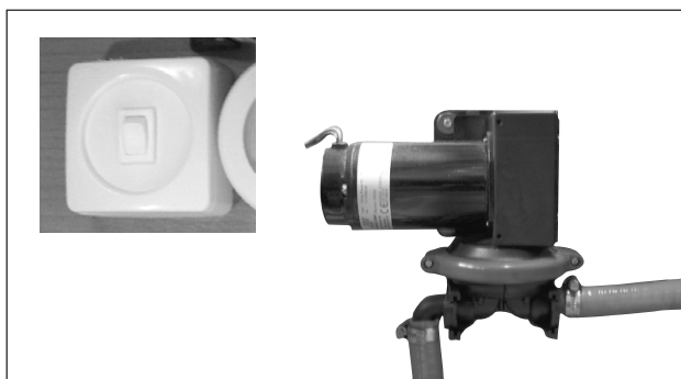
Gråvattentankens tömningspump och dess strömbrytare.
