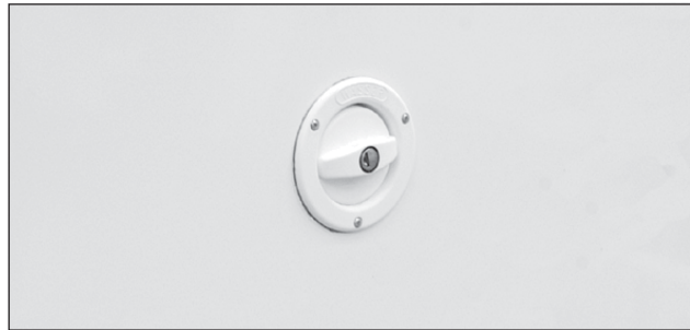
Påfyllning av färskvatten.
