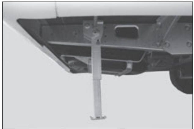
Stödbenet nervevat för att stabilisera husbilen.
