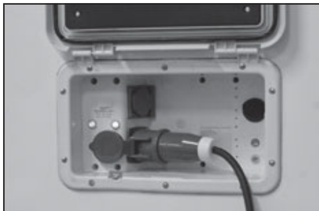
Uppvärmning med elpatron förutsätter 230V matning.
