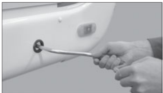
Stödbenets manövernred är åtkomligt genom hålet i husbilens dekorkant.
