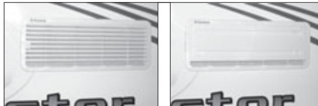
Kylskåpets ventilationsgaller vid sommarbruk respektive med vinterlucka monterad.
