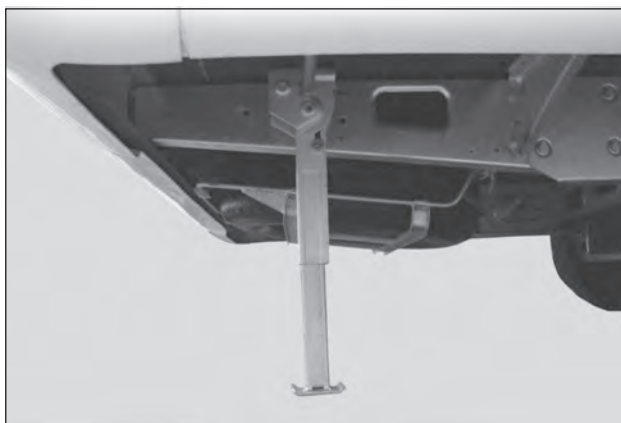
Stödbenet nervevat för att stabilisera husbilen.
