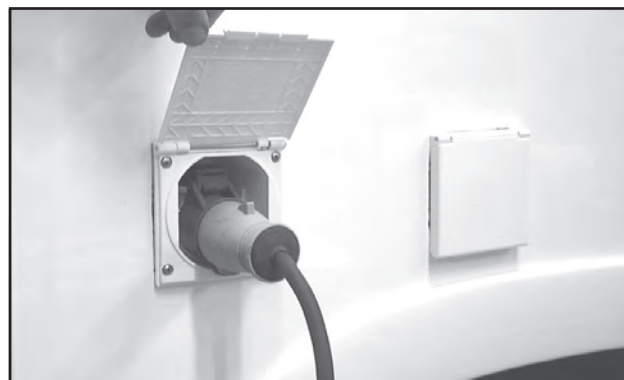
Uppvärmning med elpatron förutsätter 230V matning.
