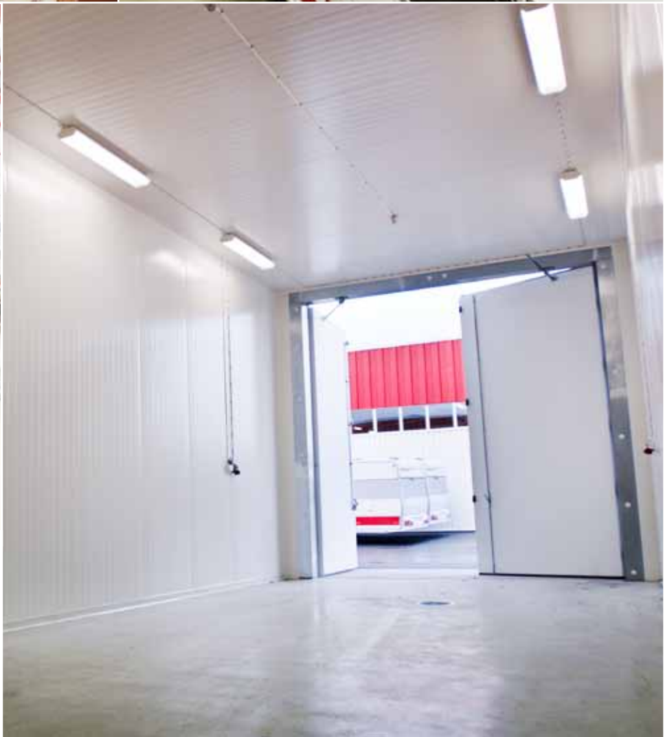
Mikael Blomqvist, teknisk chef på KABE, visar den enorma köldkammaren som är unik i branschen; här testas både husvagnar och husbilar – till och med den 11 meter långa Hacienda får plats – i -30° och upp till +55°. Överst; 4 individuella vågar finns fast monterade i golvet. I regnkammaren besprutas vagnarna och bilarna under högt tryck.
