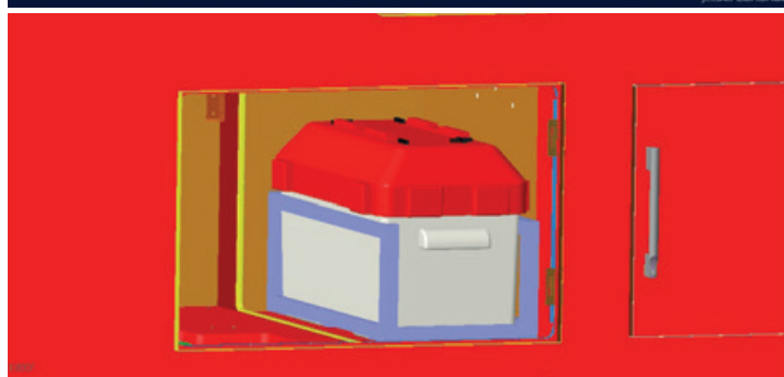
Stålram vid batteri.
