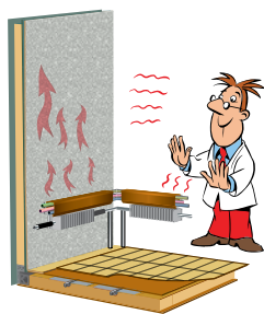
Värmen från radiatorerna sprids upp utefter väggarna. Innerplåten i väggarna fördelar värmen ut över hela väggen.
