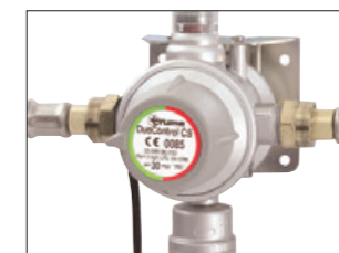
Duocontrol. Duocontrol har inbyggd automatisk gasomkopplare, reduceringsventil och krocksensor som löser ut vid sammanstötning med en G-kraft på 3,5 G. Gasotillförseln stängs då av direkt för att undvika gasoläckage. Duo Control är godkänd i hela Europa för att ha gasolen igång under färd.
