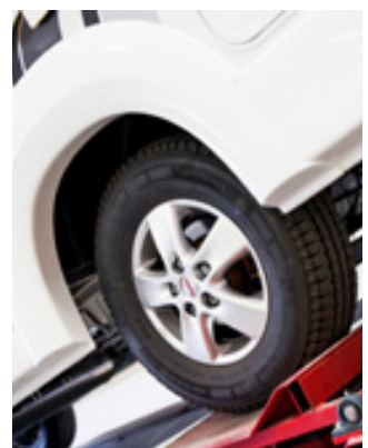
Hållbarhetstest simuleras i en skakbänk motsvarande 10 000 mil normal körning.
