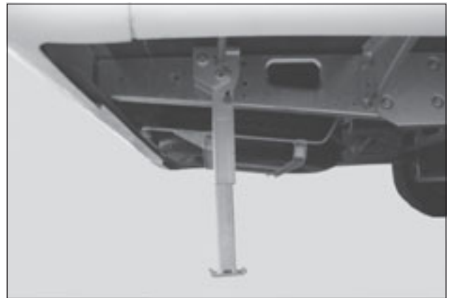
Stödbenet nervevat för att stabilisera husbilen.
