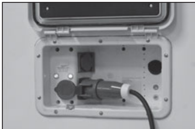
Uppvärmning med elpatron förutsätter 230V matning.
