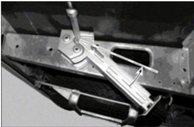
Stödbenet ska vevas upp ända till sitt övre läge.
