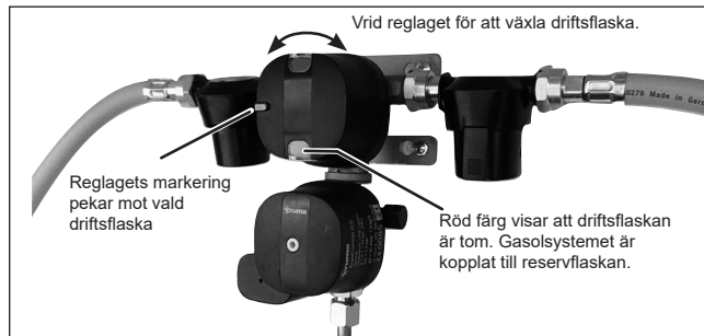
Truma DuoControl är avsedd för två gasolflaskor.
