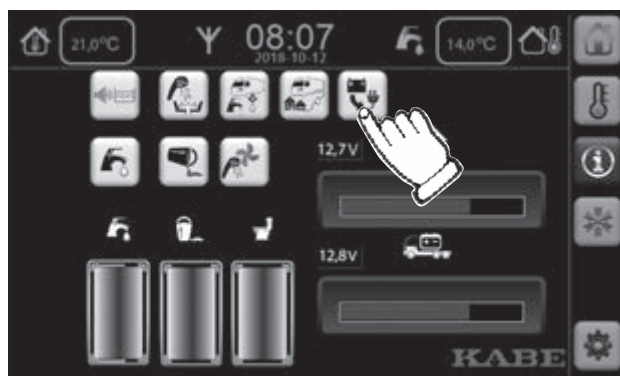
Starta och stäng av Invertern på manöverpanelen.
