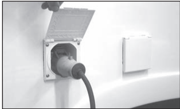
Uppvärmning med elpatron förutsätter 230V matning.
