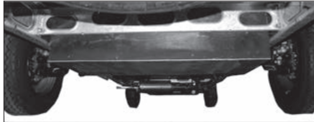
Gråvattentanken monterad mellan husbilens bakhjul.
