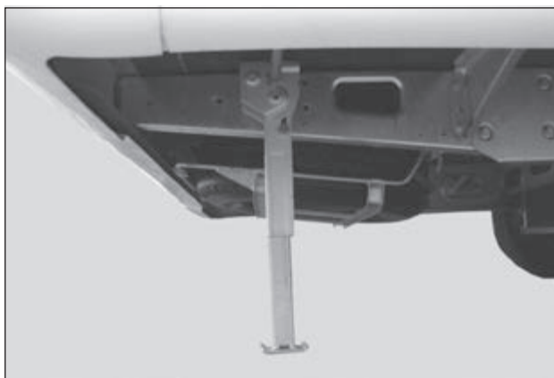
Stödbenet nervevat för att stabilisera husbilen.
