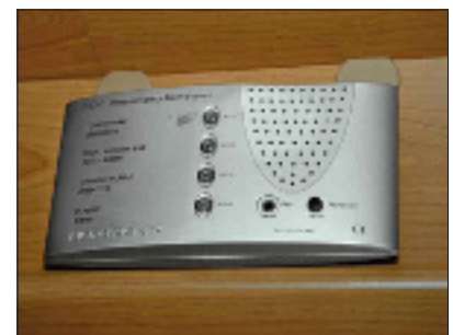
Säkerhetslarm Y0314 Larm som klarar det mesta; tunga och lätta narkosgaser, gasol och brandrök.
