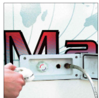
Utvändigt duschuttag Y0100 Med varmvatten.
