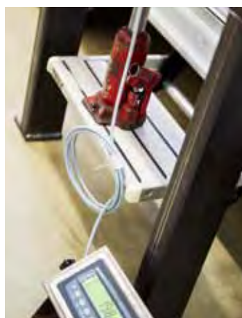
Tryck används för att testa hållfastheten hos produkterna.
