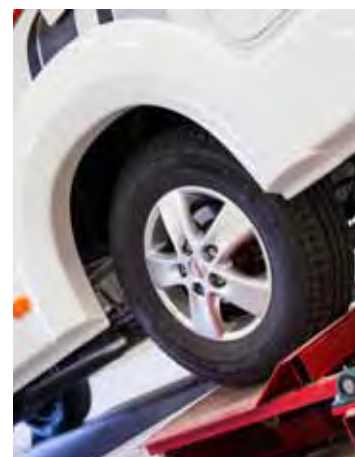
Hållbarhetstest simuleras i en skakbänk motsvarande 10 000 mil normal körning.
