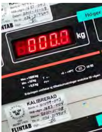
Vågar för att balansera och optimera viktfordelning mellan axlar.
